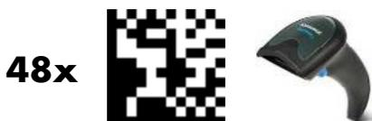
An der Verpackungsstation werden alle DataMatrix-Codes gescannt, wenn die Produkte in die Schale gelegt werden. Ein sehr großer QR-Code wird generiert und auf ein normales Papier gedruckt. Papier und Tray werden ESD-verpackt und versiegelt.
