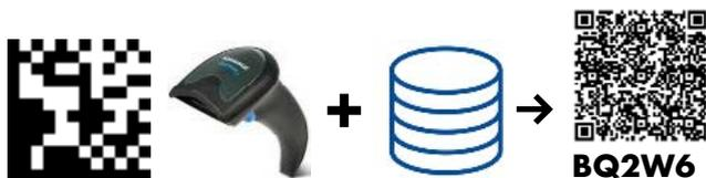
An der Montagestation für das endgültige Produktgehäuse scannt er die DataMatrix auf dem Gerät und kann mit den Informationen aus seiner Datenbank den B2L-QR-Code einschließlich des Produktnamens erzeugen. Der Kunde kann das B2L-Label auf das Gerät kleben.
